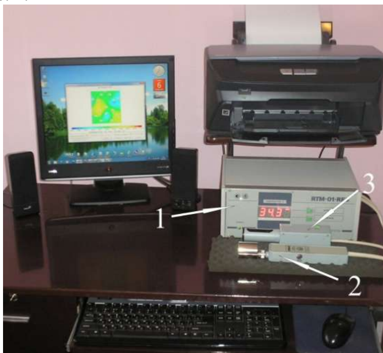
Рис. 2. Диагностический комплекс РТМ-01-РЭС: 1- блок обработки информации, 2 – микроволновый датчик, 3 – инфракрасный датчик.
